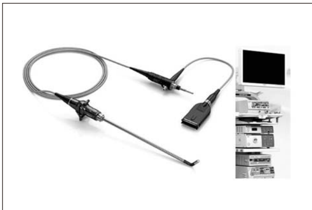
図5 HD内視鏡システム (10 mm フレキシブルスコープ (LTF-S190-10)、VISERA ELITE (OTV-S190) : オリンパス社) HD による画質向上に加え、カメラ先端が自在に屈曲するため、狭空間での視野作りに優れている。
