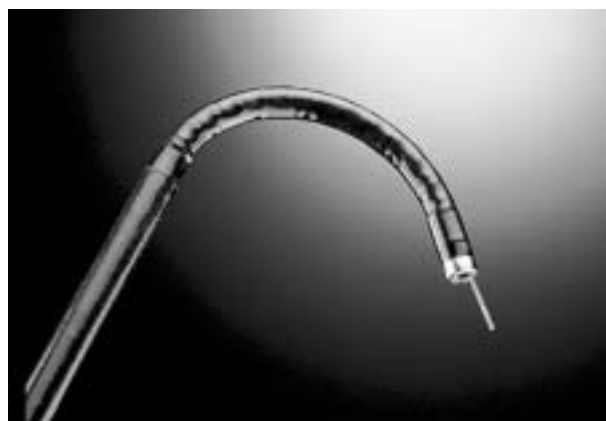
図7 200 \mu m の石英ファイバーの柔軟性
