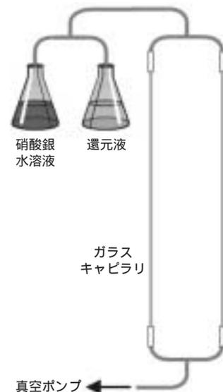
図4 銀成膜装置の概略図
